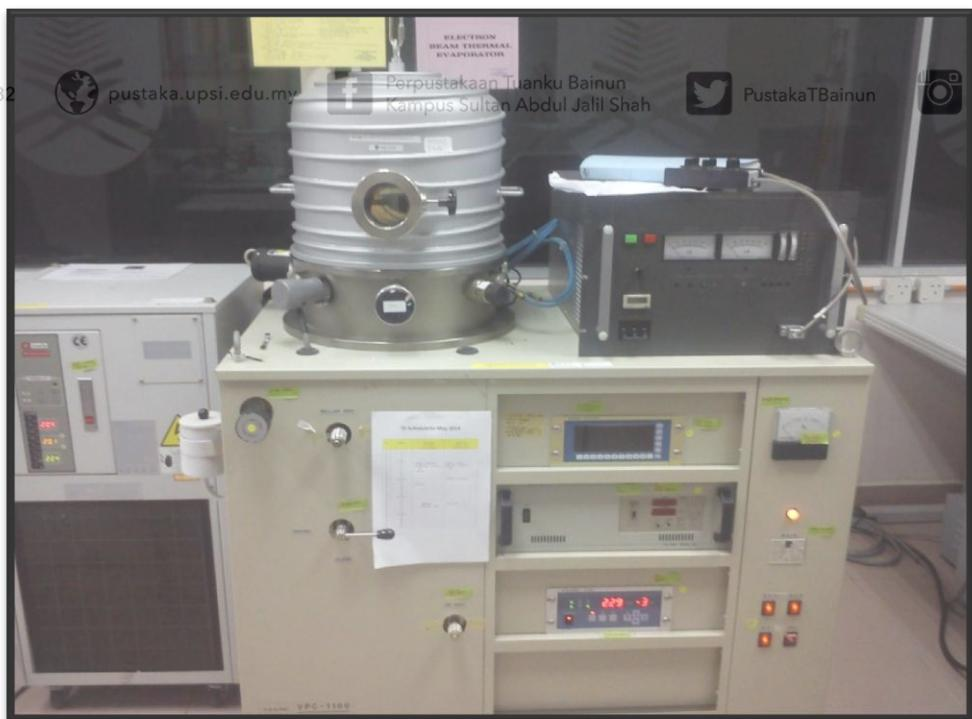
Rajah 3.12 Thermal Evaporator yang digunakan untuk pemendapan emas pada sampel kaliks[8]arina + NTK.
