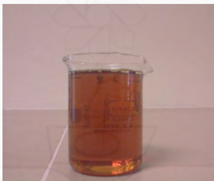
Rajah 3.4. Minyak masak terpakai yang digunakan sebagai sumber karbon untuk pertumbuhan nanotiub karbon.
