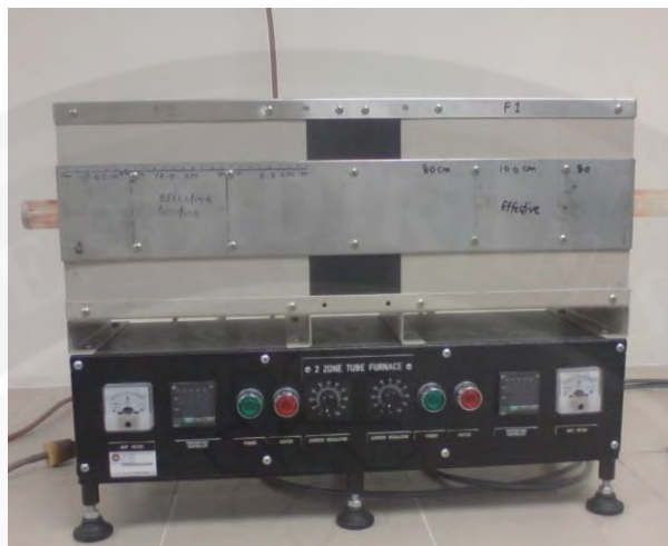
Rajah 3.3. Reaktor pemendapan wap kimia haba untuk menghasilkan nanotub karbon yang berada di makmal NANO, Jabatan Fizik, UPSI.
